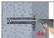
La bomba de soplado se puede utilizar para tamaños de anclaje de hasta 20mm de diámetro de perforación.
