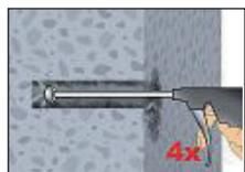
**Después de la limpieza, el agujero debe protegerse contra la recontaminación de manera adecuada, hasta que se dosifique el mortero en el mismo. Si es necesario, la limpieza repetida ha de ser directamente antes de dispensar el mortero. El agua entrante no debe volver a contaminar el agujero.**
