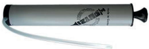
Bomba de soplado (volumen 750 ml) Diámetro de la broca ( d_0 ): 10 mm a 20 mm y profundidad del anclaje hasta 240mm
