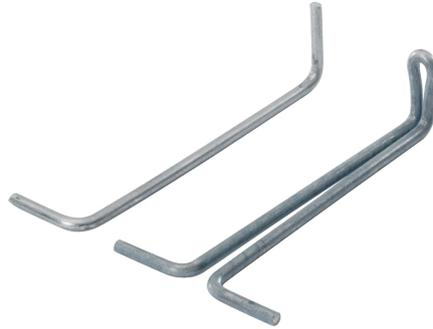
Las grapas de amorterar "GAS" y "GAD" son un sistema de fijación para aplacados de piedra amorterada. Estas grapas, sin soldaduras, por un lado van fijadas a un determinado soporte o a la edificación en sí, y por el otro lado a la placa de piedra.
